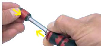
Ohne Betätigung der Hülse wird der Bit in die Aufnahme geschoben. Sobald der Bit in einer Schraube angesetzt wird, verriegelt er sich selbstständig und sitzt sicher und wackelfrei.
